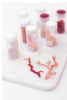
精炼的珊瑚粉末。我们了解到即使是同一种珊瑚,研磨颗粒大小不同也能形成多种多样的颜色。精製した珊瑚末。同じ珊瑚からでも粒子の大きさにより多様な色ができることが分かる
