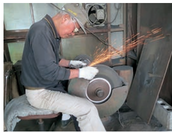
淬火之前，先使用研磨机初步定型 焼き入れ前にグラインダーを使って生仕上げ
