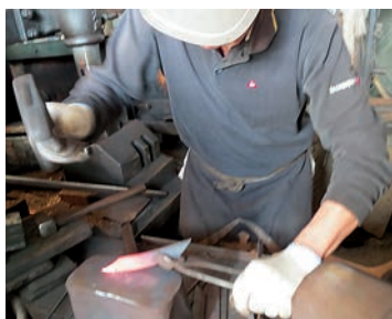
鎌刀制作の第一工序→将钢夹入铁中，然后在1000度的炉膛里烧红，再用铁锤锻打。
